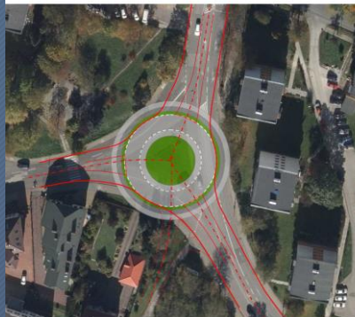
STARACHOWICE - PRZEBIEG DROGI WOJEWÓDZKIEJ NR 744 PRZEZ MIASTO PROPOZYCJE PRZEBUDOWY SKRZYŻOWAN skrzyżowanie al. Armii Krajowej / Jana Kilńskiego przebudowa skrzyżowania na rondo (średnica zewn. 35 m)
