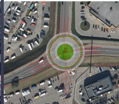
STARACHOWICE - PRZEBIEG DROGI WOJEWÓDZKIEJ NR 744 PRZEZ MIASTO PROPOZYCJE PRZEBUDOWY SKRZYŻOWAN skrzyżowanie al. Armii Krajowej / Kardynała Stefana Wyszyńskiego przebudowa skrzyżowania na rondo (średnica zewn. 35 m) rezerva na 4 wlot - do Spółdzielczej
