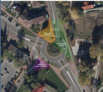
STARACHOWICE - PRZEBIEG DROGI WOJEWÓDZKIEJ NR 744 PRZEZ MIASTO PROPOZYCJE PRZEBUDOWY SKRZYŻOWAN skrzyżowanie al. Armii Krajowej / Jana Kilńskiego przebudowa skrzyżowania na rondo (średnica zewn. 35 m)
