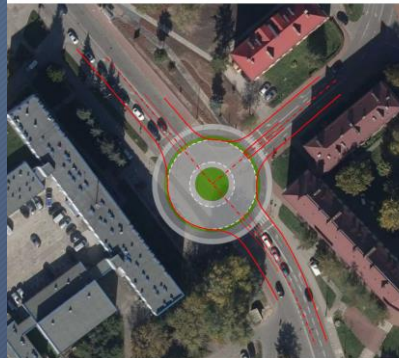
STARACHOWICE - PRZEBIEG DROGI WOJEWÓDZKIEJ NR 744 PRZEZ MIASTO PROPOZYCJE PRZEBUDOWY SKRZYŻOWAN skrzyżowanie al. Armii Krajowej / Kościelna przebudowa skrzyżowania na rondo (średnica zewn. 30 m)
