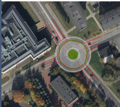
STARACHOWICE - PRZEBIEG DROGI WOJEWÓDZKIEJ NR 744 PRZEZ MIASTO PROPOZYCJE PRZEBUDOWY SKRZYŻOWAN skrzyżowanie al. Armii Krajowej / Kościelna przebudowa skrzyżowania na rondo (średnica zewn. 30 m)
