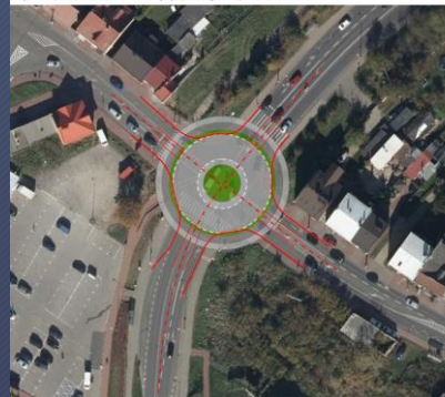
STARACHOWICE - PRZEBIEG DROGI WOJEWÓDZKIEJ NR 744 PRZEZ MIASTO PROPOZYCJE PRZEBUDOWY SKRZYŻOWAN skrzyżowanie al. Armii Krajowej / Iłżecka przebudowa skrzyżowania na rondo (średnica zewn. 30 m) powiększenie ronda z wyspa i regulacja własności
